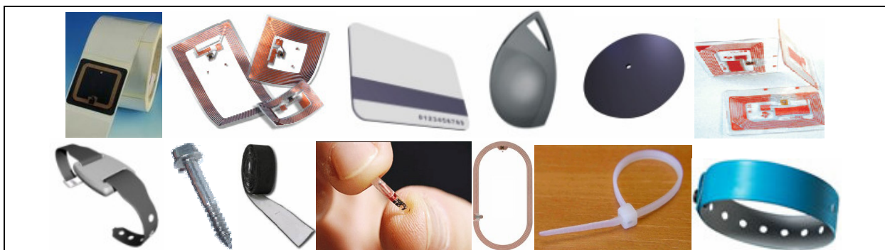
Figura 2. De izquierda a derecha y arriba abajo: Adhesivas de papel, Adhesivas sin sustrato, Tarjetas, Llavero, Disco, Plásticas de alta resistividad, Pulsera, En clavo, Integrada en textil, Implantable, Para inyección en plástico, En brida, Brazalete. (www.nextpoints.com)
